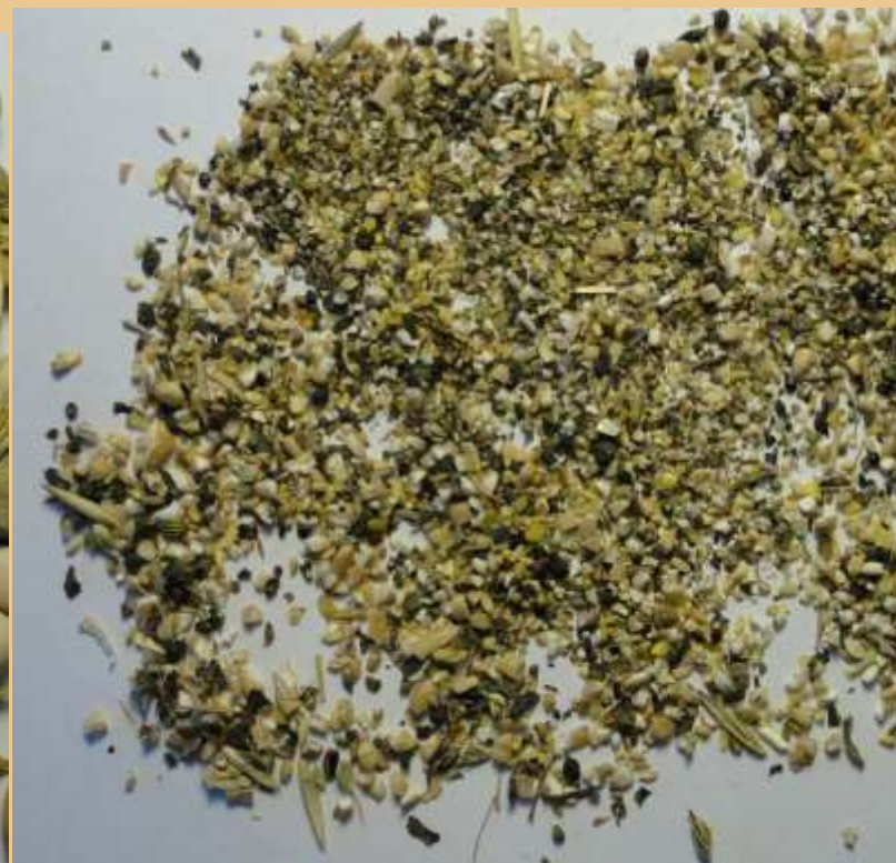
пропад нижнего сита 1,8 мм (дробленные части и порошок)
