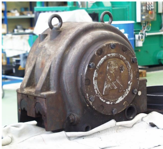
Старый корпус на призмах для сферического роликоподшипника
